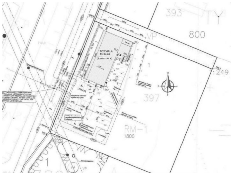
Kuva 13 Suunnitellun rakentamisen asemapiirros
