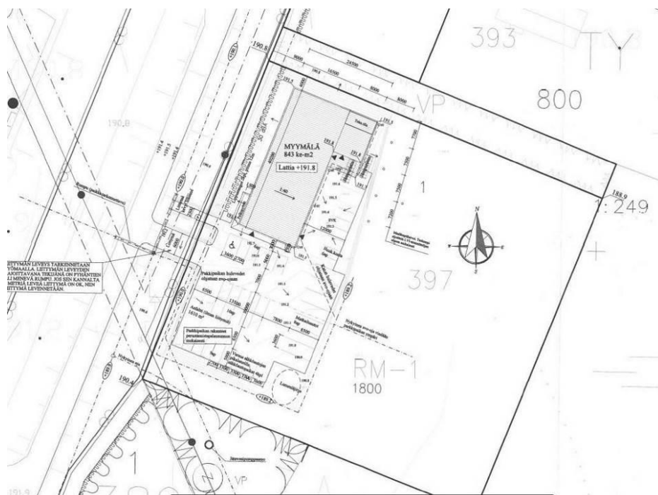
Kuva 11 Suunnitellun rakentamisen asemapiirros
